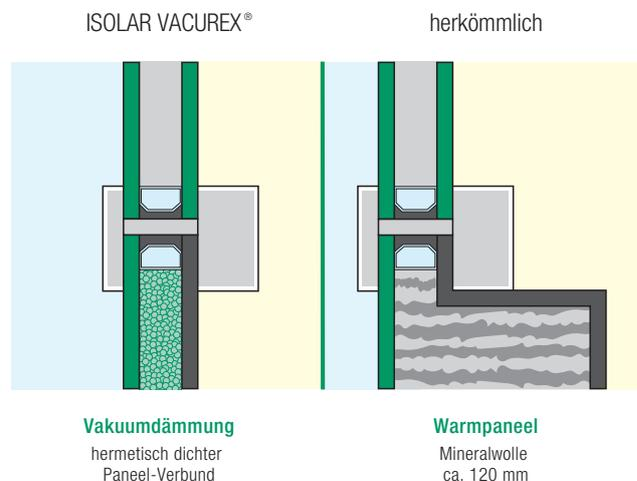
ISOLAR VACUREX® kann mit Zusatzeigenschaften moderner Multifunktionsgläser ausgestattet werden, so zum Beispiel mit erhöhter Schalldämmung von 44 dB oder angriffhemmenden Eigenschaften.
